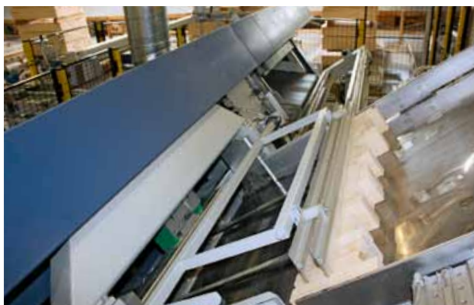
Der Tisch wird gekippt: Bei der Superkurzholzanlage nutzt NKT bei der Zuführung zur Fräseinheit die Schwerkraft
