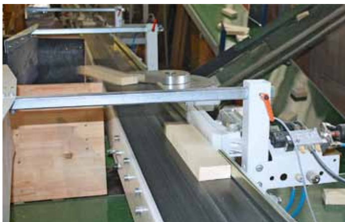
Auswerfer im Test: Im Vordergrund ein Pusher, danach ein Exzenter, der die längeren Werkstücke sauber und vor allem leise auswirft
